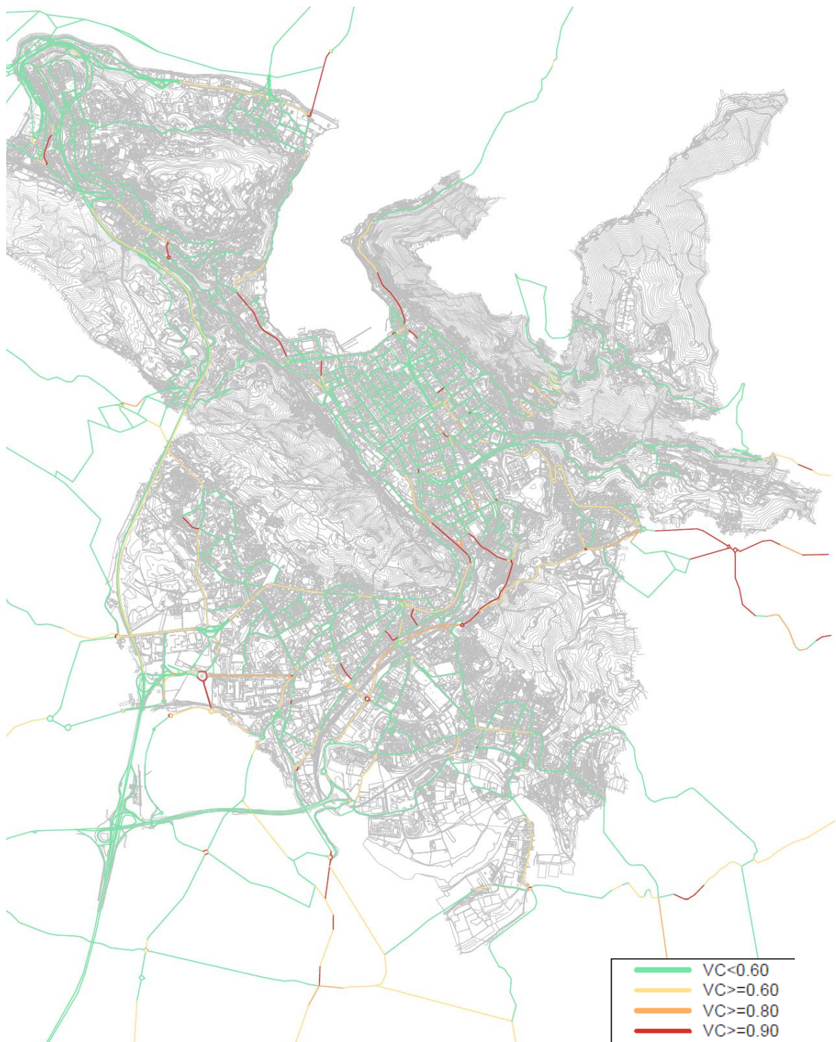
Figura 51 - Scenario di breve termine ora di punta del mattino (7:30-8:30) - Rapporto tra volumi di traffico (in veicoli equivalenti) e capacità delle strade (rapporto V/C)
